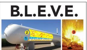
1 BOILING LIQUID 2 EXPANDING VAPOR 3 EXPLOSION
